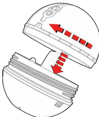
Для обеспечения герметичности перед использованием крышку прибора необходимо плотно закрутить, убедившись, что уплотнительное кольцо не повреждено.
