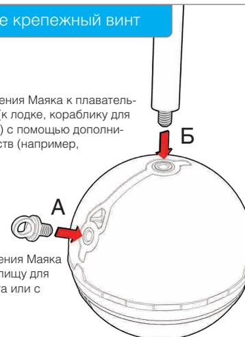
Б - точка крепления Маяка к плавательным средствам (к лодке, кораблику для прикормки и пр.) с помощью дополнительных устройств (например, струбцины).
